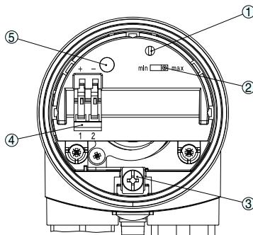
Отсек электроники и подключения - двухпроводный выход
